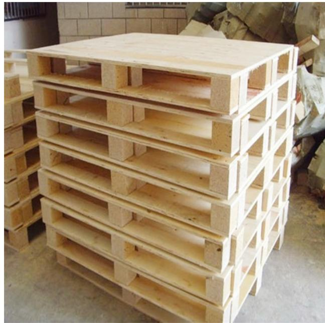
“免熏蒸木托盘”是指出口免熏蒸、免消毒、免签证的木托盘，与熏蒸木托盘相比，其出入境更方便快捷。该木托盘的消毒方法有使用药物和热处理两种，使用的药物是溴甲烷、环氧乙烷。将待熏蒸木托盘上的货物堆放整齐，用覆盖物将货物封住，但要留出一个角作投药口。在遮盖物下、货物旁放一盆清水，将药液注入水中。免熏蒸木托盘制造企业。将预留的投药口压紧，使需熏蒸的木托盘在完全密封的情况下保持24小时。打开遮盖通风，待毒气散尽后搬运货物，大约需要18-24小时。加热方式是指当木托盘处理时，木材的中心温度达到560℃，并保持至少30分钟。执行以上任何一项操作的木托盘都需要加上包含IPPC标志ISO标准国家代码的标记，以证明免熏木托盘按规定处理。该标识为多数国家认可，出入境时无需办理任何手续即可在进口国直接通关。以雄厚的资金实力，精湛的技术支撑，先进的生产设备，为广大群众提供质量的装船运输产品。并有完善的管理及售后服务，为客户提供前列的服务。本公司具有多型号全组装可调式货架和组装平台的能力。产品用途广，在消费者中形成了良好的口碑。免熏蒸木托盘制造企业。
